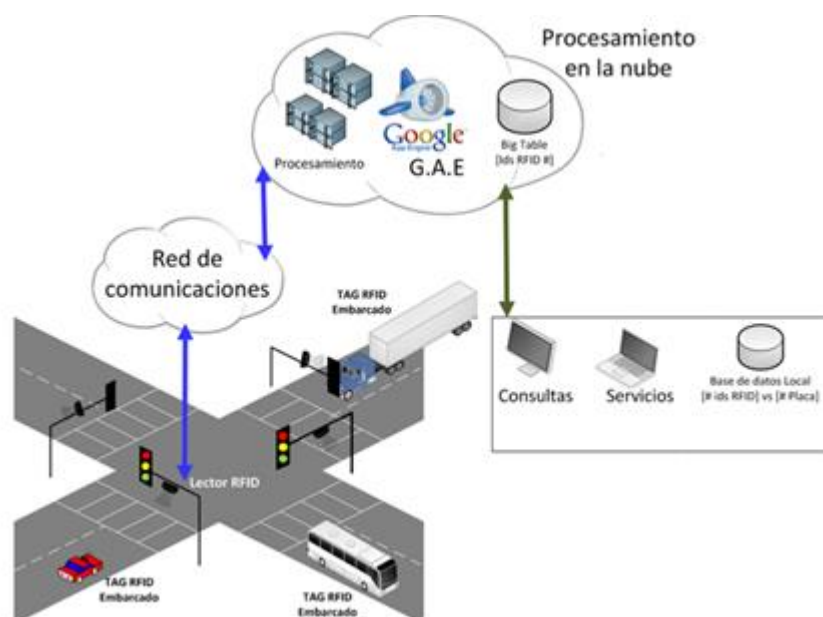
Figura 1 Arquitectura del sistema de detección de vehículos
