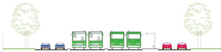
Figura 4: Diseño Tipo 3 ( T_3 ), Dos Pistas Continuas
