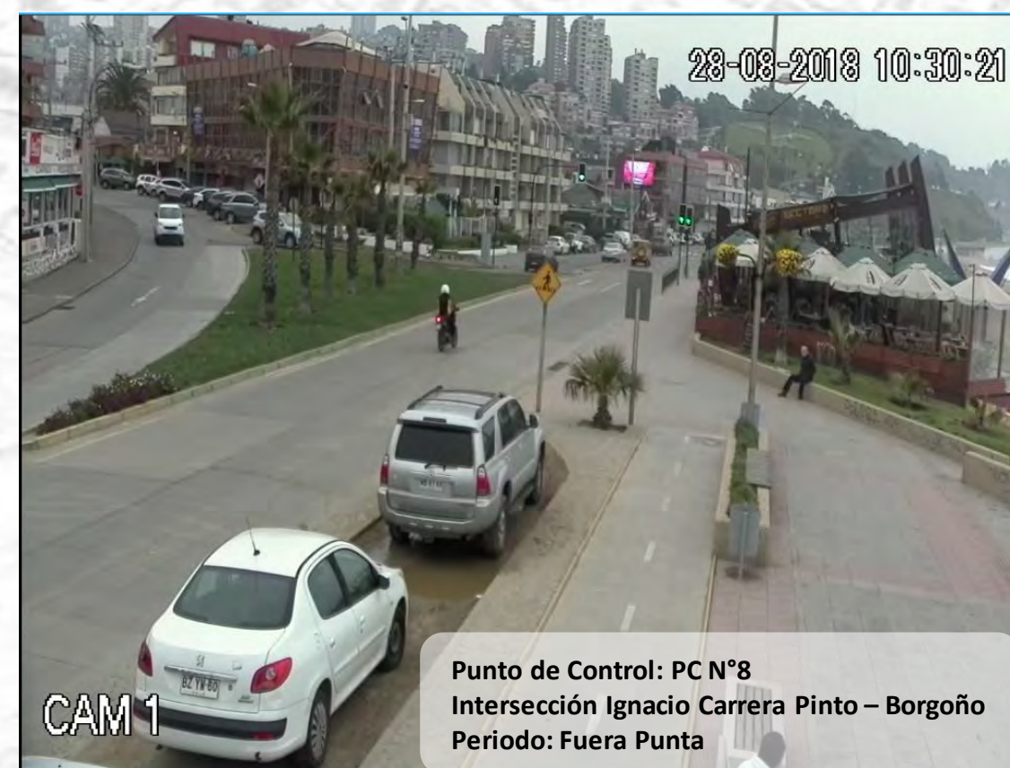
Ejemplo Medición de flujo vehicular con cámaras
