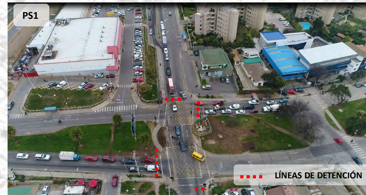
Ejemplo Medición de flujo de saturación con Drone
